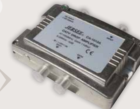
ZT01 CA-1011A, G=15dB / F10dB, max. 115dBuV, 1xOUT zesilovač jedno vstupý 47-862MHz / ret. 5-30MHz
