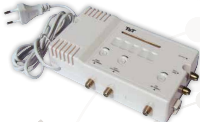
ZT11 AM-1041FL LTE, G=30 dB F=10 dB R=-18 dB OUT=105 dBuV zesilovač tří vstupů VKV + UHF(1) + UHF(2), vč. zdroje
