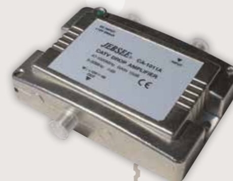
ZT02 CA-1012A, G=11dB / F10dB, max. 115dBuV, 2xOUT zesilovač jedno vstupý 47-862MHz / ret. 5-30MHz
