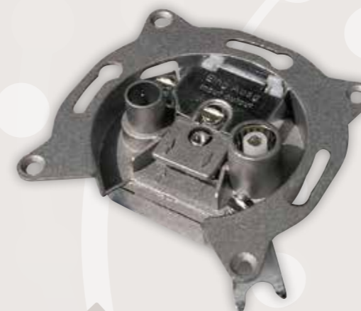
UZ01 EU3601A koncová TV(1 dB)+R(2 dB) UZ02 EU3607S průběžná TAP TV+R (7 db), IN-OUT (4 dB) UZ03 EU3610S průběžná TAP TV+R (10 db), IN-OUT (3 dB) UZ04 EU3614S průběžná TAP TV+R (14 db), IN-OUT (1,5 dB)
