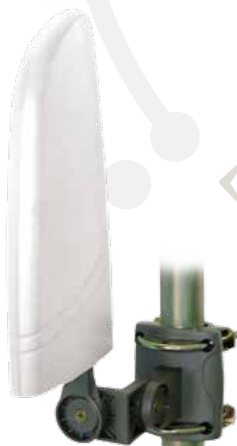
AN14 DA-2692A venkovní, VHF-III 15dB, UHF 15dB aktivní se zesilovačem, napájení 5V/100mA DC v pásmu VHF-III. 174-230MHz, UHF 470-862MHz zisk VHF 18dB, UHF 15 dB všesměrový příjem pro místní příjem signálu
